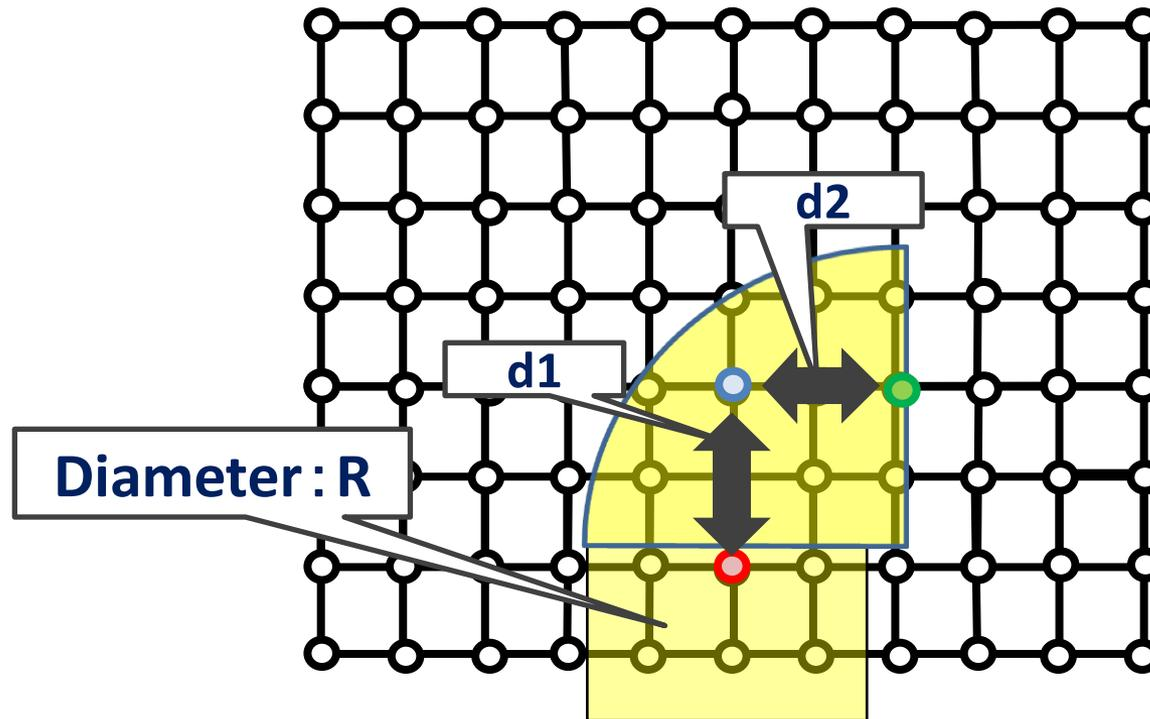
**Cost of a Elbow :  $(d1 + d2 + 0.1) \times R$**
