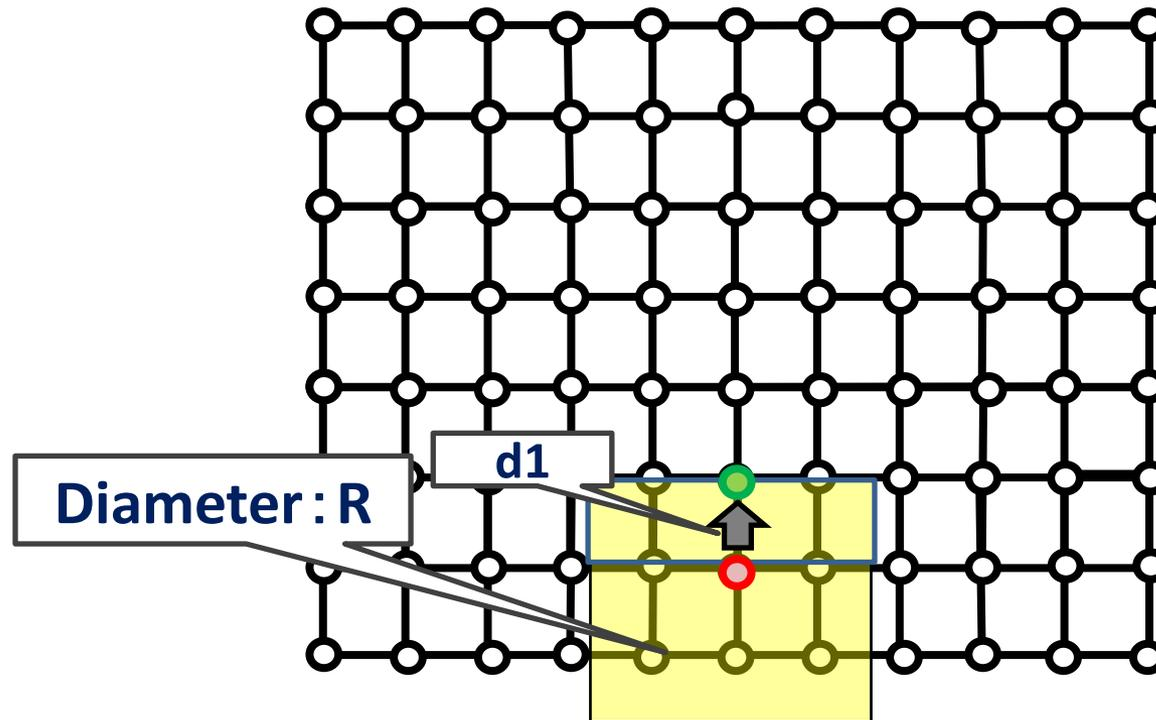
**Cost of a Straight Pipe :  $1 \times R$  per 1m**
